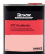
62C Accelerator è un additivo per i prodotti Durepox. Grazie all'aggiunta di un 5% massimo, in volume, di 62C Accelerator, i tempi di indurimento e pot life risultano approssimativamente dimezzati.
